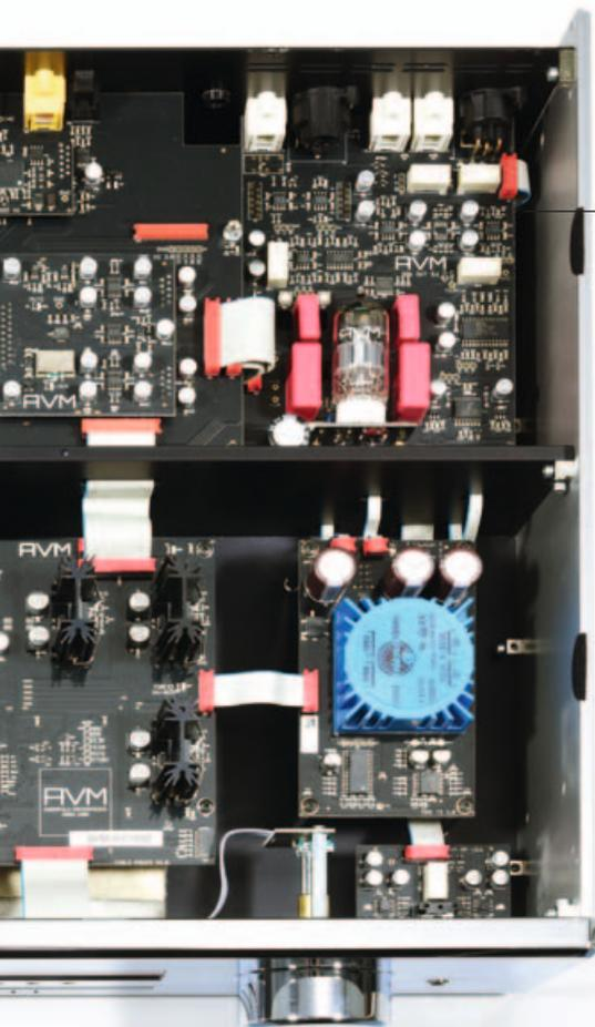
**KEIN RIESENTRAFO:** Der Ovation 8.3 versorgt seine Endstufen per Schaltnetzteil. Unten rechts findet sich ein kompakter Stromaufbereiter – für den Class-A-Kopfhörerverstärker.
