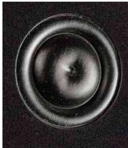
Keine Angst, niemand hat hier den Hochtöner eingedrückt. Die mittige Delle ist Teil der Form des phantastisch auflösenden Ringstrahlers
