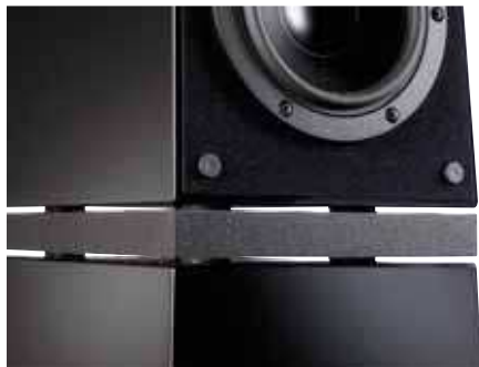
Eine dicke MDF-Scheibe und Schwingungen stark absorbierende Sorbothan-Scheiben trennen die Gehäusemodule voneinander
